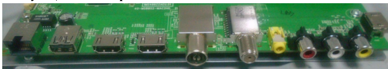
LAN USB 2.0 HDMI1 HDMI2 ANTENNA/ CABEL IN SATTELITE IN AV OUT AV IN
